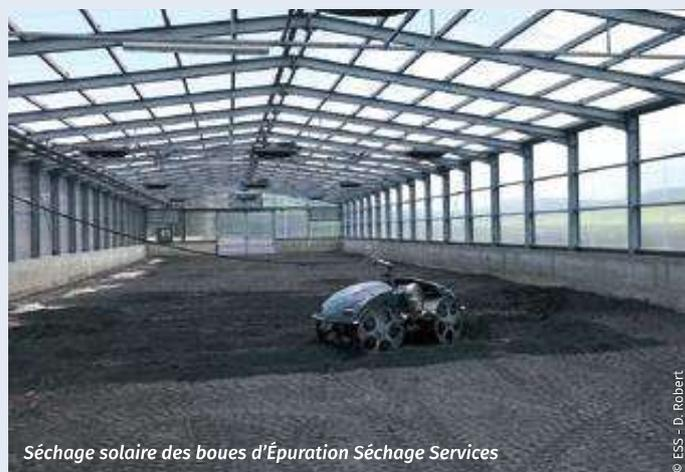
Séchage solaire des boues d'Épuration Séchage Services
